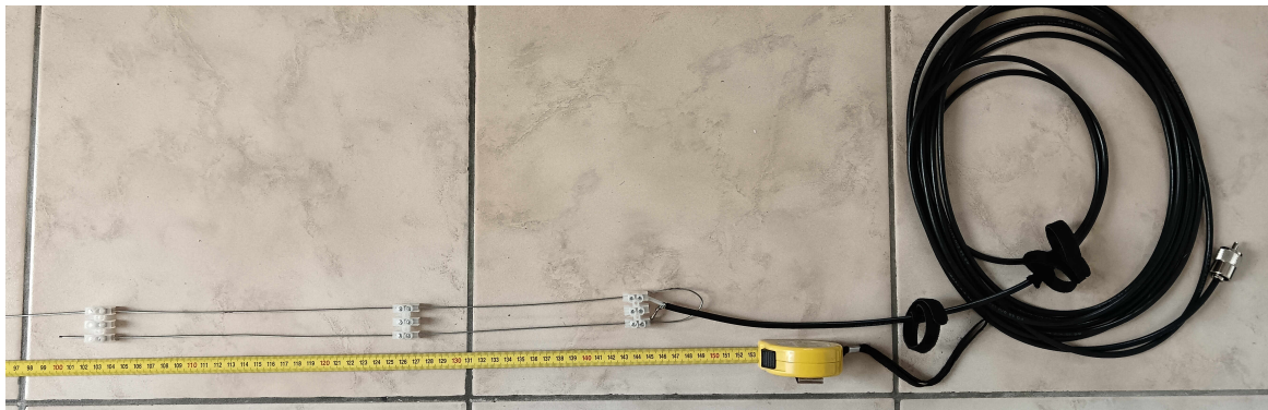
8. ábra. A teljes negyedhullámú illesztő transzformátor
