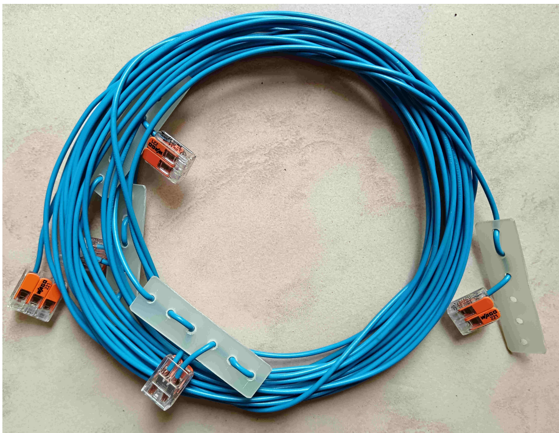
12. ábra. A dipól egyik szára feltekerve: itt csak 10-15-20-40 m
