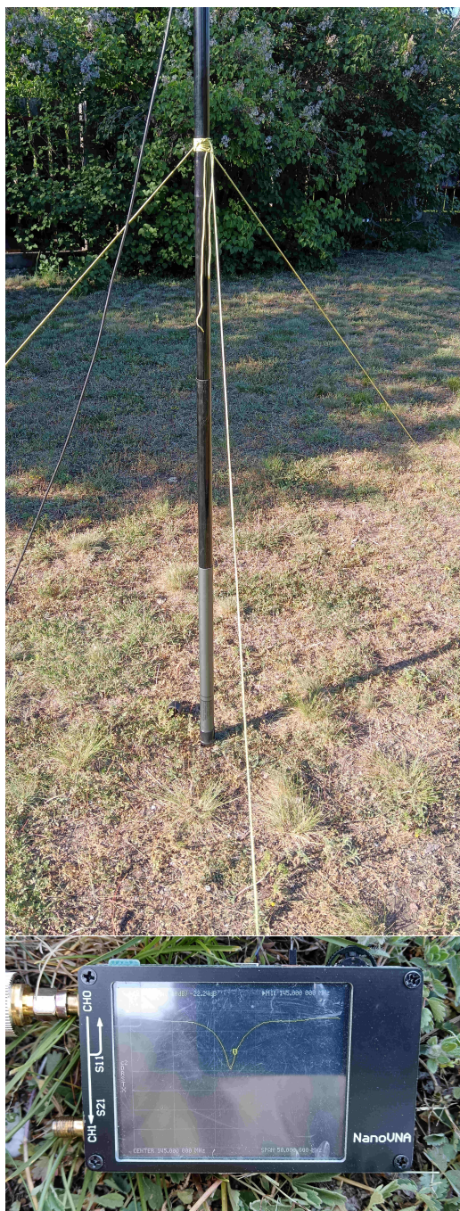
11. ábra. J-antenna a pecaboton + VNA-s mérés
