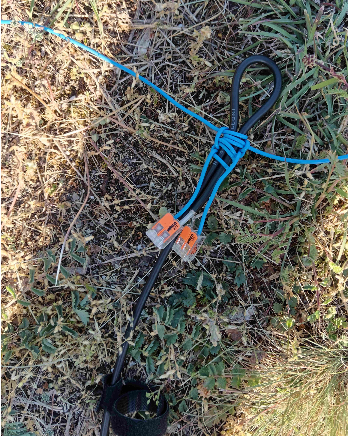
14. ábra. A dipól közepe a koaxszal
