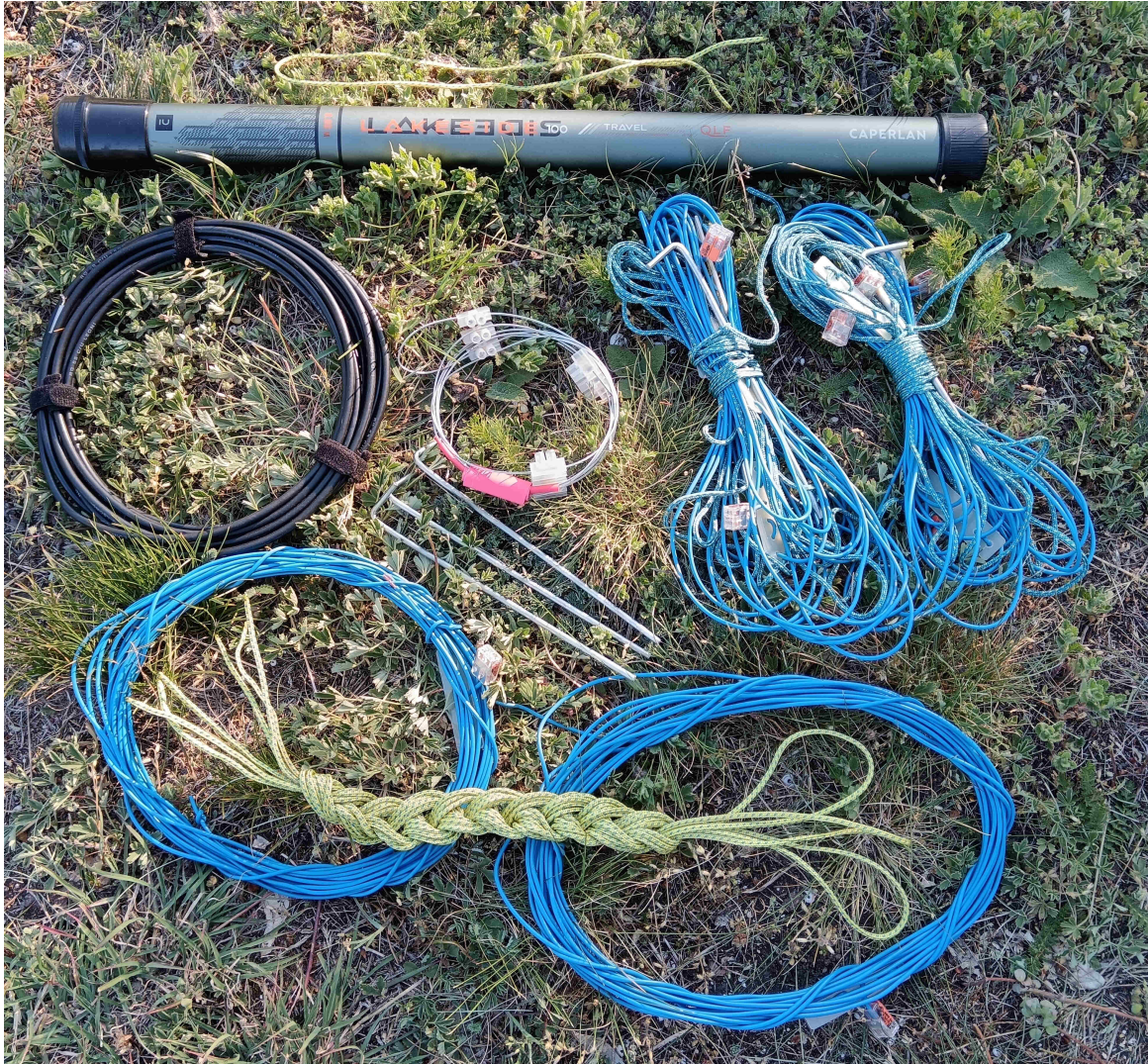
1. ábra. J-antenna 2 m-re, többsávós rezonáns félhullámú dipól rövidhullámra
