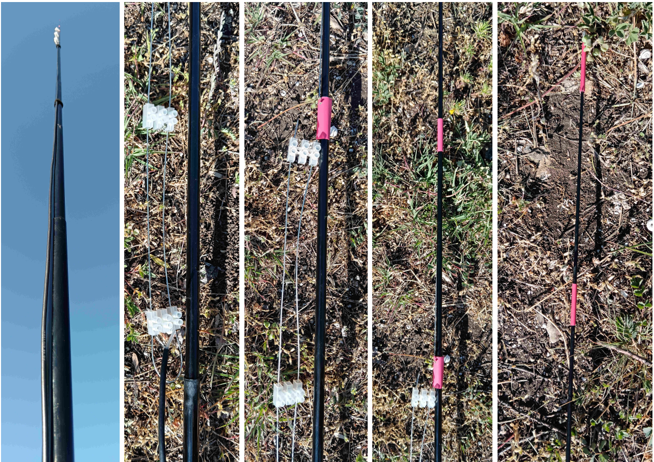
10. ábra. J-antenna pecaboton
